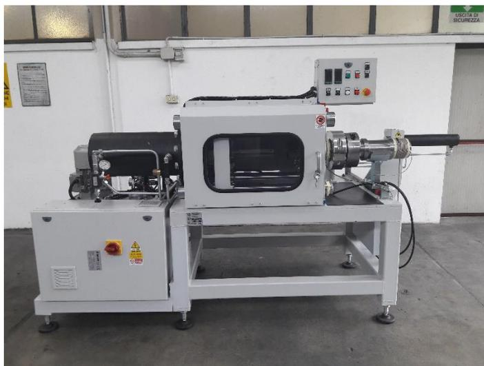
La macchina, ha la funzione di estrudere la carota ottenuta dalla preforma, dando al prodotto la forma desiderata in ragione della **filiera**. Viene data la possibilità di scegliere una disposizione verticale od orizzontale della macchina a seconda delle **esigenze di ingombro**.
