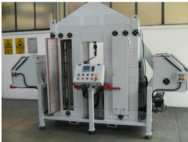
La macchina, ha lo scopo di eliminare dal prodotto additivi ed oli (i quali possono essere **riciclati**). Può lavorare singolarmente, con **controllo in velocità**, oppure in linea con la calandra, con **controllo in coppia**. La
