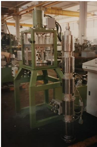
La macchina è in grado di produrre tubi in PTFE di grosso spessore e tondi pieni.
