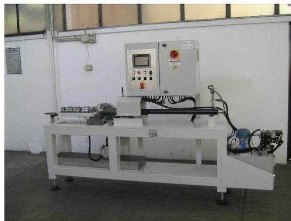
La macchina, ha il compito di compattare il blend di polvere e additivi, ottenendo così un cilindro dalle **dimensioni desiderate**, atto ad essere trasformato dalle successive lavorazioni di estrusione.
