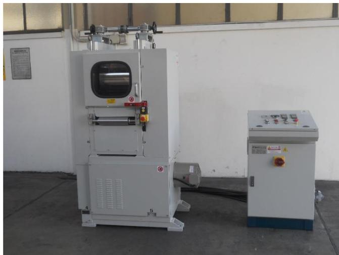
La macchina, ha la funzione di eseguire la lavorazione di laminazione del prodotto ottenuto dall'estrusione, qualora si decida di ottenere un film di **spessore desiderato**. La macchina è controllata elettronicamente **in C.A. con inverter vettoriali**.
