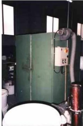
La macchina, ha il compito di stabilizzare le molecole di PTFE, a seguito della lavorazione precedente, in modo tale da ottimizzare le caratteristiche del materiale, rendendolo idoneo alle lavorazioni successive.
