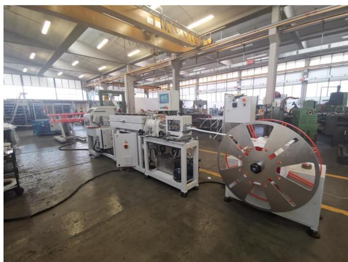
Macchina automatica in grado di corrugare tubi a **parete sottile.** Essa è in grado di corrugare tubi con un diametro massimo di 1".
