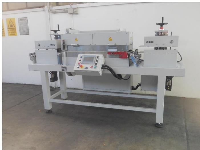
Il prodotto ottenuto, prima di passare alle fasi successive, necessita di essere sottoposto ad un ulteriore trattamento termico, atto a stabilizzarne le proprietà finali, permettendo inoltre una **riduzione dello spessore**. L'operazione di stiraggio permette di ottenere in uscita un prodotto che presenta una **lunghezza maggiorata fino a 12 volte**, rispetto alla lunghezza iniziale. Il controllo di stiratura è elettronico, e la tecnologia di riscaldamento è di tipo "**infrared**".
