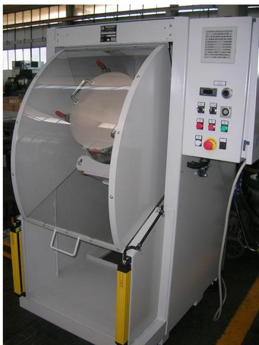
La macchina viene utilizzata per miscelare opportunamente le polveri e gli additivi, ottenendo così, dopo un certo periodo di tempo, un prodotto amalgamato e con una consistenza pastosa, pronto per gli step successivi di lavorazione. Durante la lavorazione la botte compie delle oscillazioni verso l'alto e verso il basso in modo tale da miscelare al meglio i componenti.
